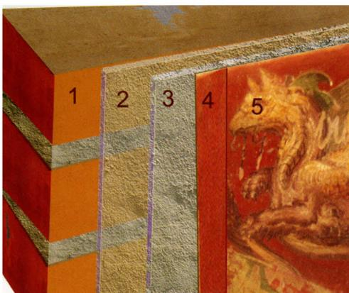
Estrato compositivo: 1. Soporte de ladrillo. 2. Mortero. 3. Segundo mortero. 4. Estuquillo rojo. 5. Capa de pintura al fresco y terminada en seco.
