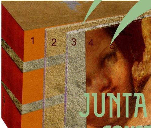
Estrato compositivo: 1. Soporte de ladrillo. 2. Mortero. 3. Segundo mortero. 4. Capa de pintura directamente al fresco.
